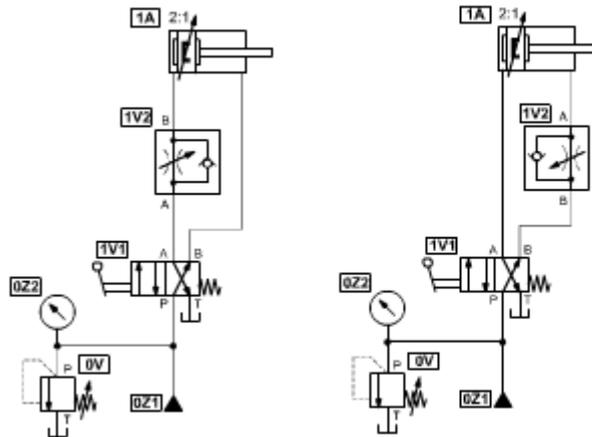
Indicar en qué caso se tendría aceite caliente circulando por el elemento de potencia (actuador) y, por ello, pérdida de precisión en posicionamiento:
